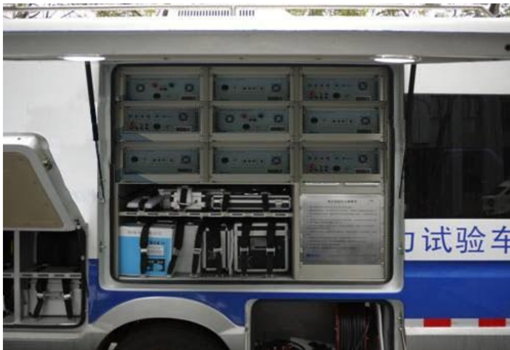
图3 KDZD接线作业平台1
